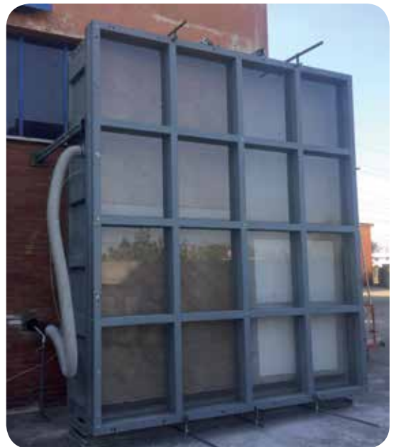
Lastre RXL dello spessore di 8 e 20 cm.
