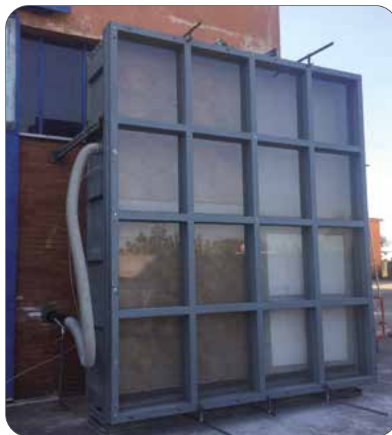
Configurazione parete: sistema spideREX K8 con lastre RXL dark (spessore 8 e 20 cm) con e senza rivestimento ceramico/lapideo.
